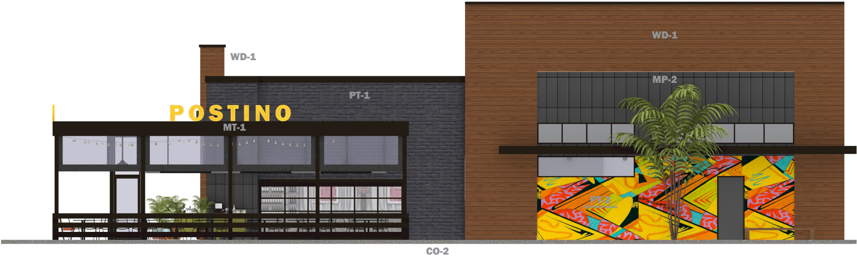
EAST FACADE ELEVATION N.T.S.
